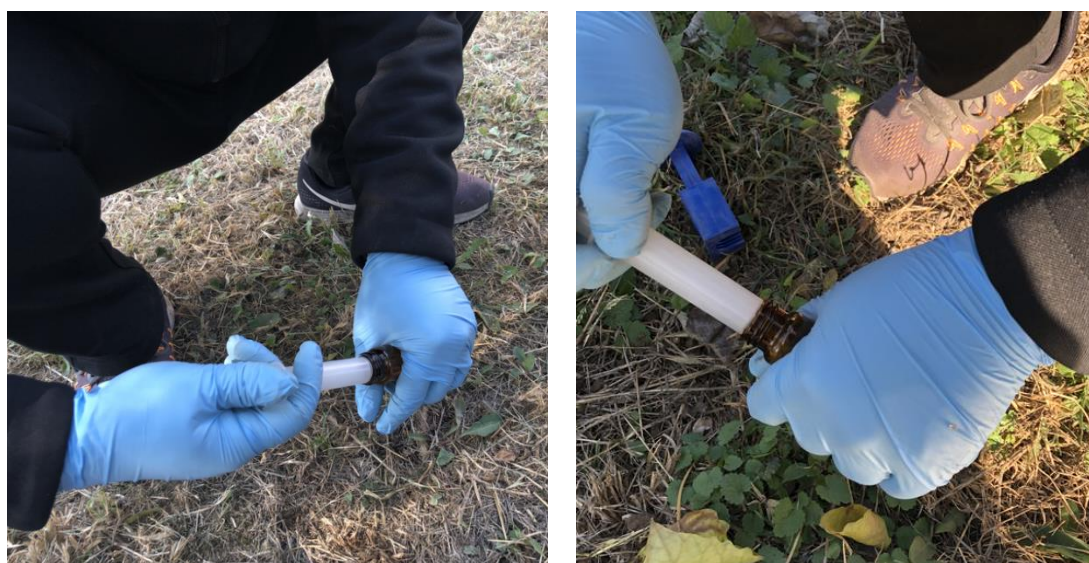
图 6 用于 VOCs 检测的土壤样品采集
