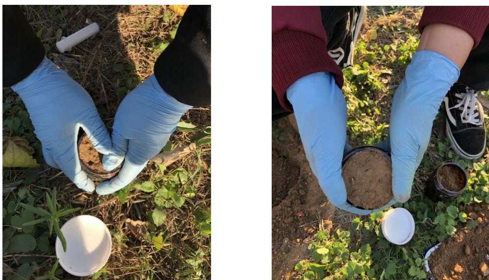
图 7 用于 SVOCs 等指标检测的土壤样品采集
