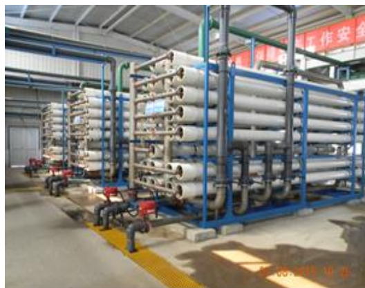
中水处理双膜装置反渗透
