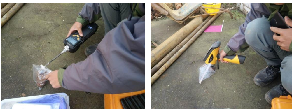
图 6 现场 VOCs 和重金属检测
