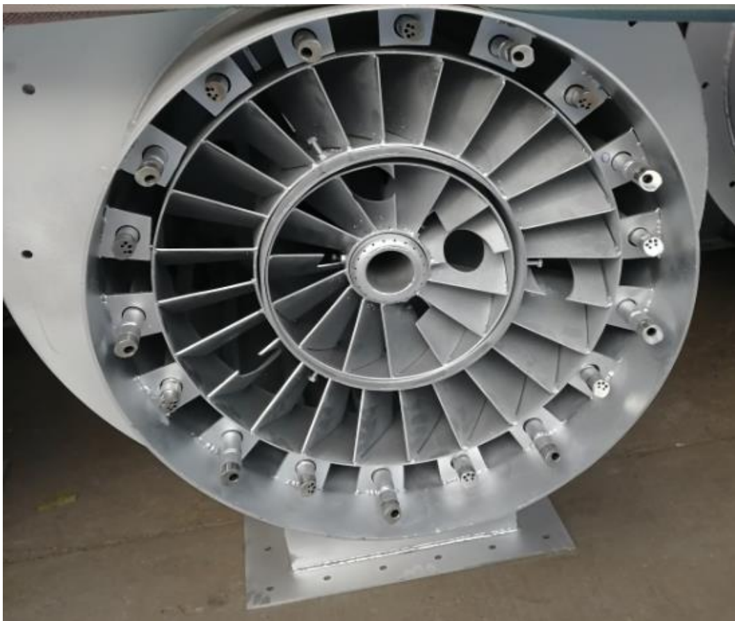
图 3.1 3#燃气锅炉低氮燃烧器
