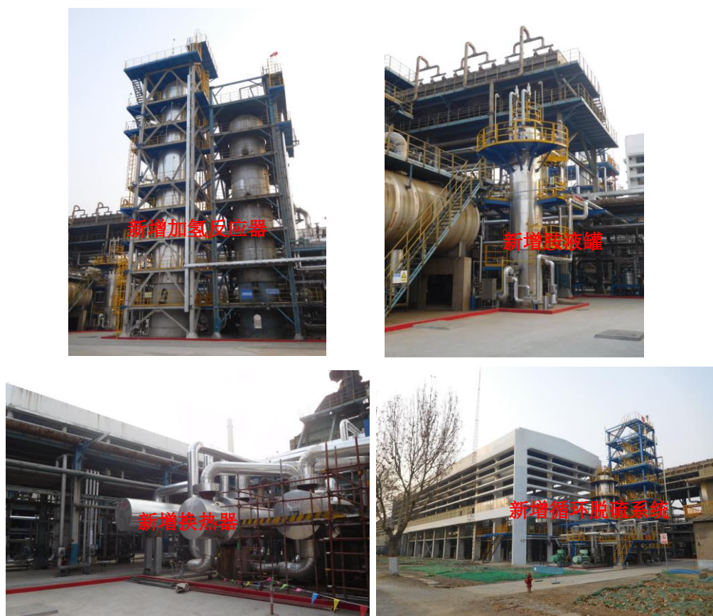
图 3-1 新增加氢反应器、胺液罐、换热器、循环氢脱硫系统
